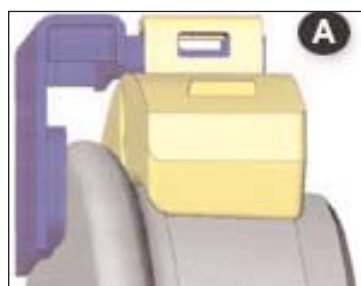
Zapata de freno operando sobre la banda de rodadura con guía cubrepestaña.
