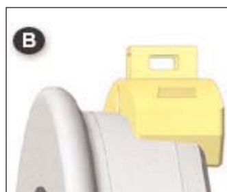
Zapata de freno operando sobre la banda de rodadura sin guía cubrepestaña.
